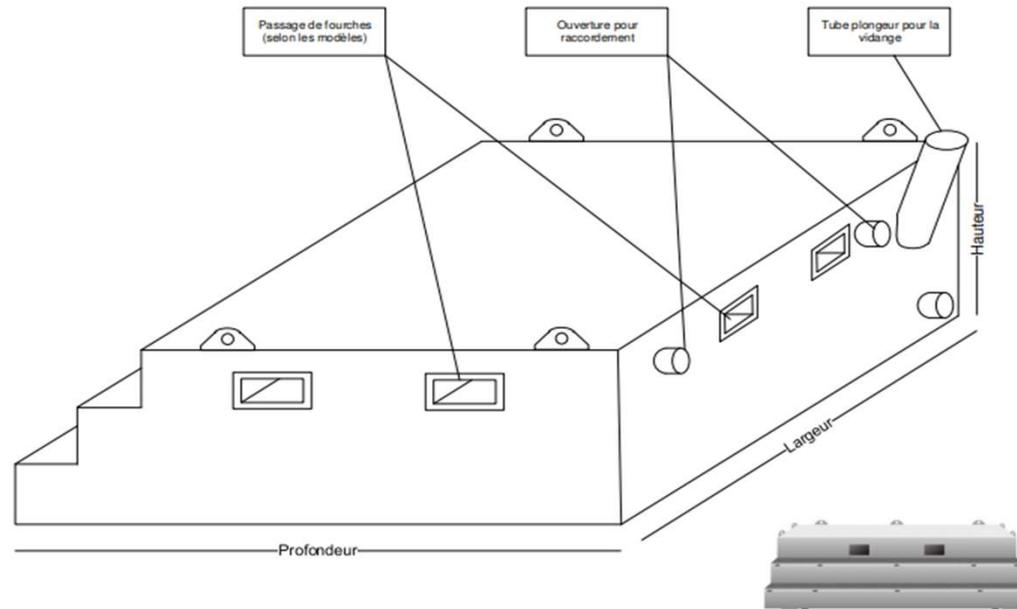
Hauteur : 485mm - Largeur : 2500mm - Profondeur : 2110mm
